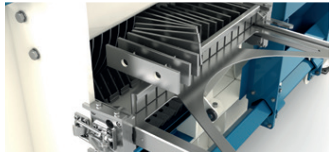
4) Установка новых молотков
